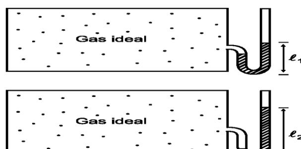
En la ciudad A, a un recipiente que contiene gas ideal se conecta un tubo en forma de U parcialmente lleno con aceite. Se observa que el aceite sube hasta el nivel  $R_1$  como se muestra en la figura. El recipiente se transporta a la ciudad B. Allí el aceite sube hasta el nivel  $R_2$  que se muestra en la figura.
