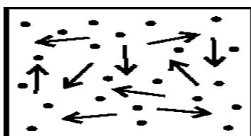
En general la temperatura del gas se puede expresar como  $T = \alpha \delta \bar{E}$  donde  $\delta \bar{E}$  es la energía promedio de las partículas del gas. En este caso  $T_0 = \alpha \delta \bar{E}$
