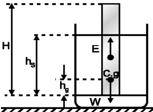
En un experimento para determinar la densidad de diferentes líquidos se usa un densímetro que es una barra cilíndrica no homogénea de longitud  $H$ , área transversal  $A$  y masa  $M$ . El centro de gravedad de la barra está a una altura  $h_g$  como se muestra en la figura. Cuando la barra flota en un líquido, el empuje está aplicado en un punto llamado centro de la flotación situado en la mitad de la altura sumergida de la barra ( $h_s/2$ )
